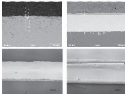
Fig. 5(a) & (b)  $\text{Si}_3\text{N}_4/\text{Cu-ABA/Kovar/Cu-ABA/W/Cu-ABA/Kovar/MBF-20/Inconel}$  joint showing (a)  $\text{Si}_3\text{N}_4/\text{Cu-ABA}$  and (b)  $\text{W/Cu-ABA}$  interfaces, (c) & (d) optical photomicrographs of a (c)  $\text{Si}_3\text{N}_4/\text{Cu-ABA/Ni/Cu-ABA/W/Cu-ABA/Inconel}$  joint, and (d) a  $\text{Si}_3\text{N}_4/\text{Cu-ABA/Ni/Cu-ABA/W/Cu-ABA/Inconel}$  joint.
